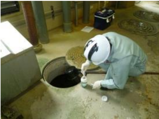
試料採取 作業(2) 浄化槽汚泥 温度測定
